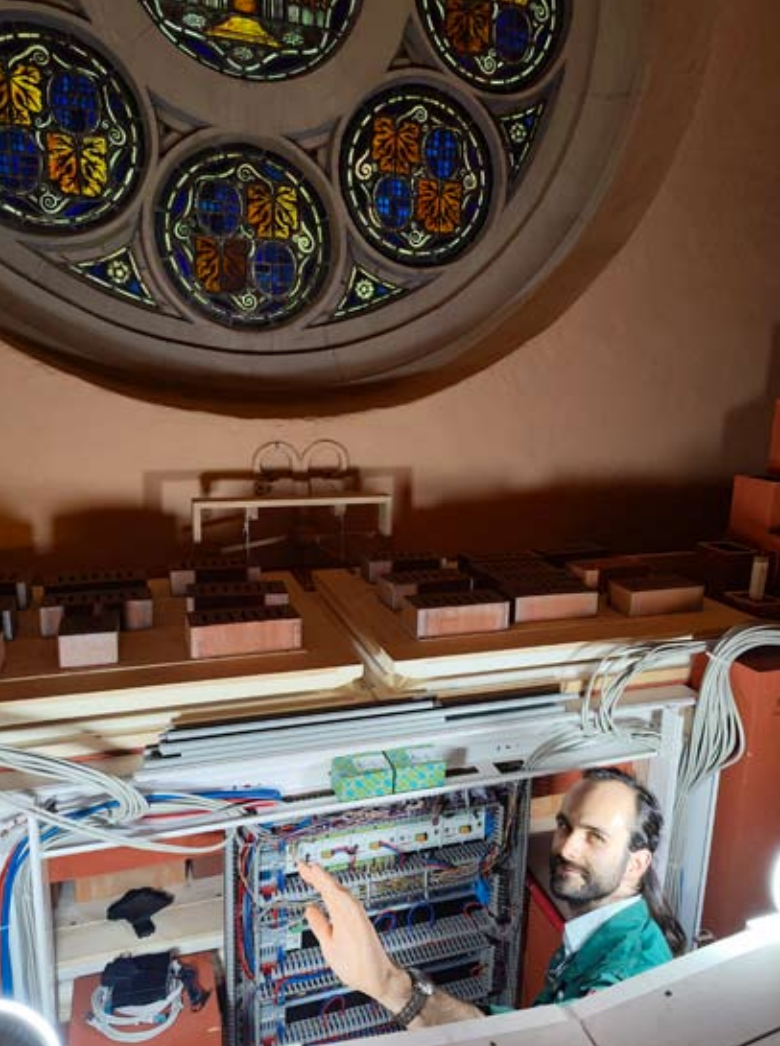
Oben links: Jonathan aus der Orgelwerkstatt Woehl sorgt dafür, dass die Orgel in Zukunft nicht nur manuell, sondern auch elektronisch angesteuert werden kann. Oben rechts: Die Orgel „füllt“ sich langsam auch von innen. Unten: „Neues Licht“ - ein kleiner Vergleich macht deutlich, was damit gemeint ist.
